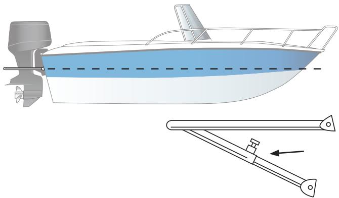
Check in the line towards the hull and deck so that the platform ends up straight. Tighten the locking bolt on the telescopic rod. / Flukta in linjen mot skrov och däck så att plattformen hamnar rakt. Skruva åt läsbulten på teleskopstaget.
