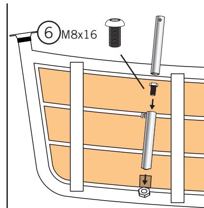
1: Kontrollera att alla delar finns med. Fäst universalbeslagen på plattformen. Skruva fast lagom så att de kan justeras mot akterspegeln. Fäst teleskopstagen under plattformen
