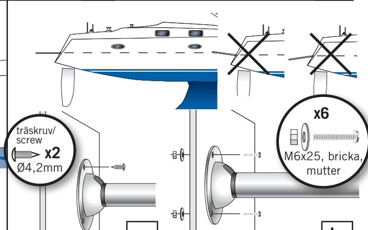
3: Fäst plattformen provisoriskt med en självgående skruv (a) i ett av hålen, fixera plattformen mot akter med hjälp av lina i pulpit. Flukta in linjen mot skruv och däck så att plattformen hamnar rakt. Fäst universalbeslagen med bultar (b) i skrovet. Ta bort skruven (a) och fäst sista bulten i varje beslag. Täta med Sikaflex.
