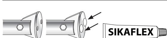
4: Fäst u-beslagen och markera med penna direkt i hålen på u-beslagen där fästhålen skall borras i akterspeglens.
