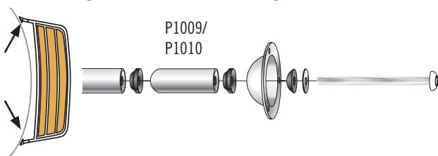
Förlängning + 50 mm finns att beställa. P1009 (Ø25 mm), P1010 (Ø32 mm). Eventuellt måste stagen(B) under plattformen bytas till ett längre (vid rak akter). Finns att beställa: P1032 (350 mm).
