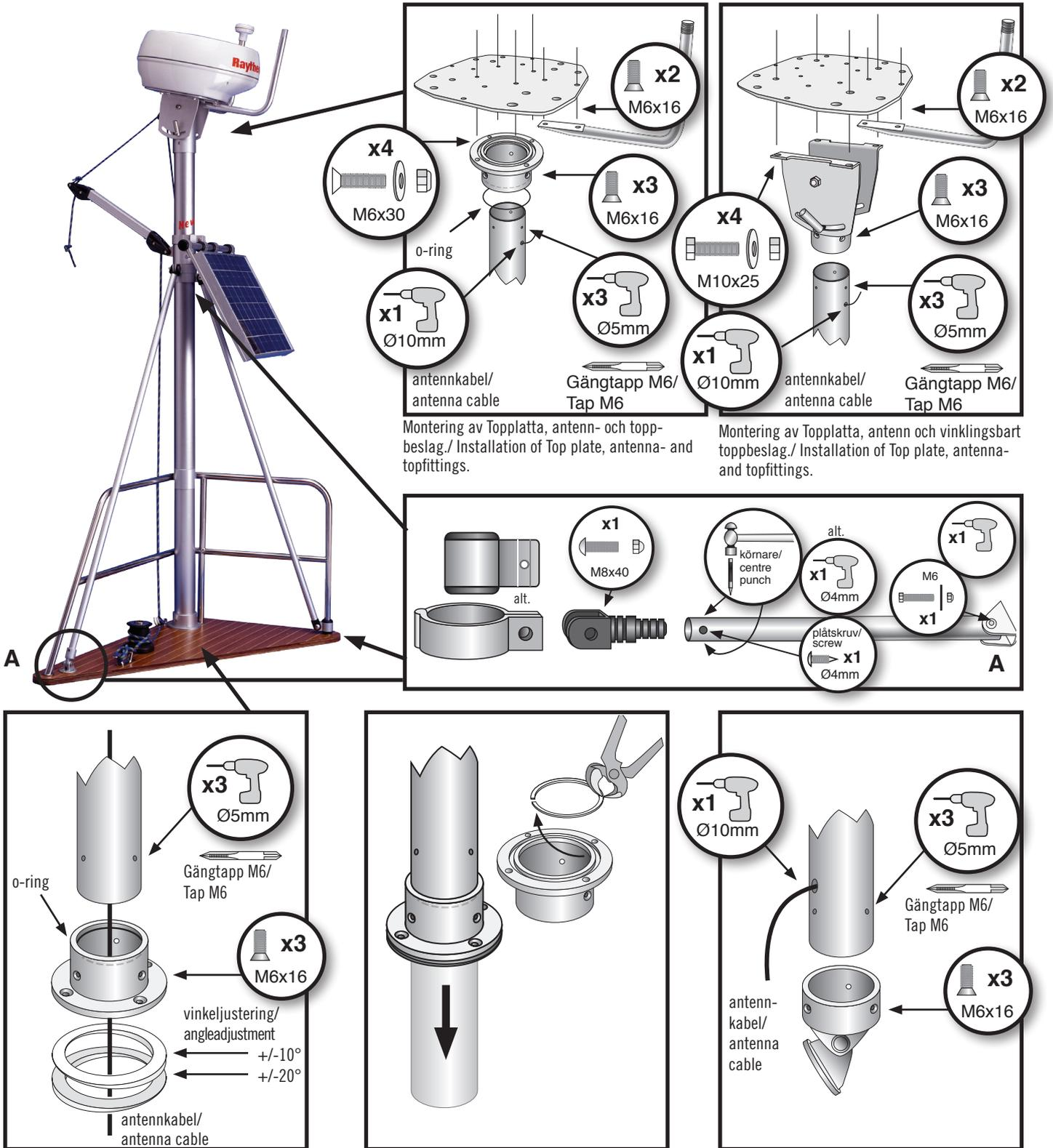
Montering av Topplatta, antenn- och toppbeslag./ Installation of Top plate, antenna- and topfittings.
